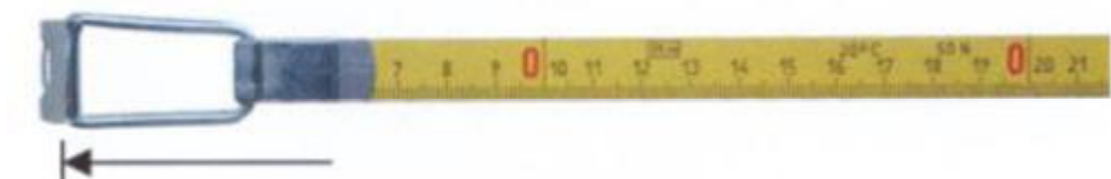
Obr. 5: Nula je umístěna na vnitřním okraji očka osazeného trnem pro zapíchnutí (nevhodné pro přesné měření)
