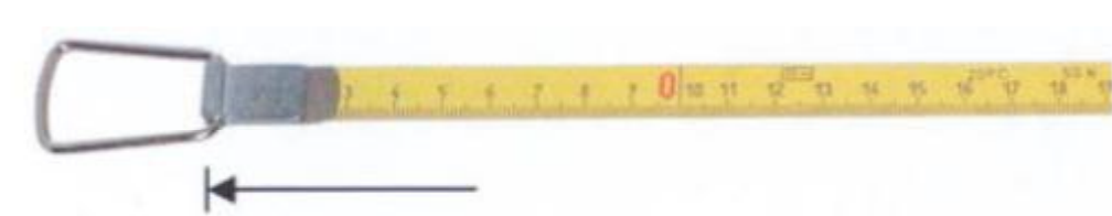
Obr. 2: Nula je umístěna v čepu očka (nevhodné pro přesné měření)
