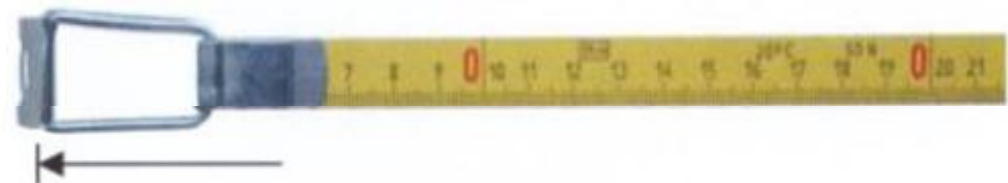
Obr. 4: Nula je umístěna v čepu očka osazeného trnem pro zapíchnutí (nevhodné pro přesné měření)
